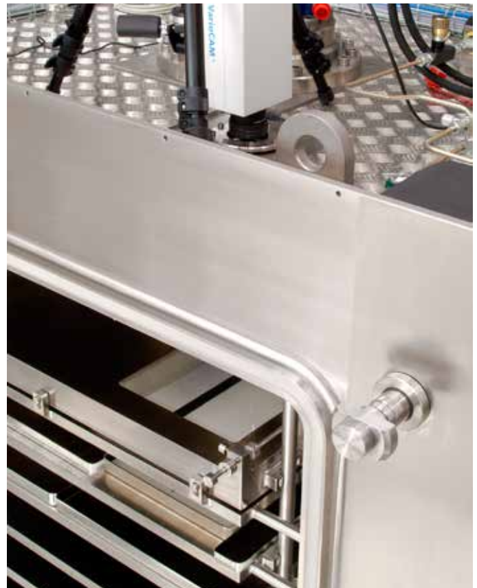
Modifikation eines Gefriertrockners für bulk API, um eine IR-Kamera zum Prozessmonitoring einsetzen zu können, zusätzlich variable Stellflächenabstände
