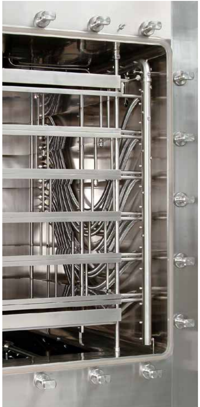
CIP-Düsenstock in einem dampfsterilisierbaren Gefriertrockner (Stellflächen paarweise zur Vergrößerung des nutzbaren Abstands gekoppelt).
