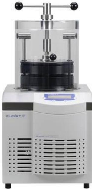
Verschlusseinrichtung mit 2 unbeheizten Stellflächen, zusätzlich Anschlüsse für 12 Rundkolben, Weithalsfilterverschlussflaschen oder Verteilerstücke für Ampullen
