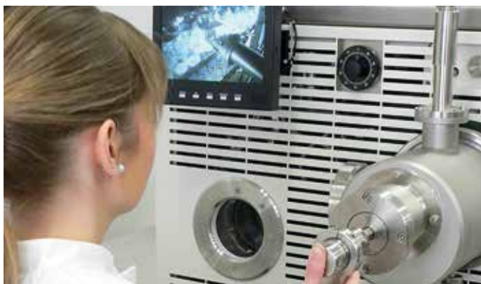
Laborantin bei der Probenentnahme während des laufenden Gefriertrocknungs-Prozesses
