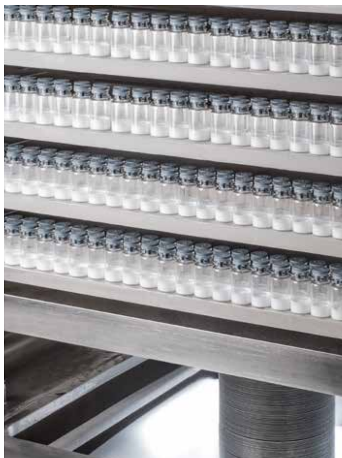
Verfahrbare Stellflächen für Vial-Trocknung mit Vial-Verschluss unter Vakuum
