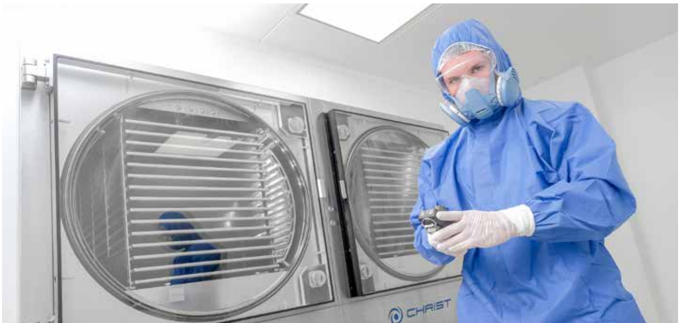
Prüfen der Raumluft nach dem Begasungszyklus von Gefriertrockner und Reinraum
