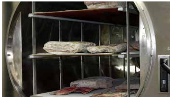
Gefriertrocknung von durchnässtem Archivgut und Dokumenten
